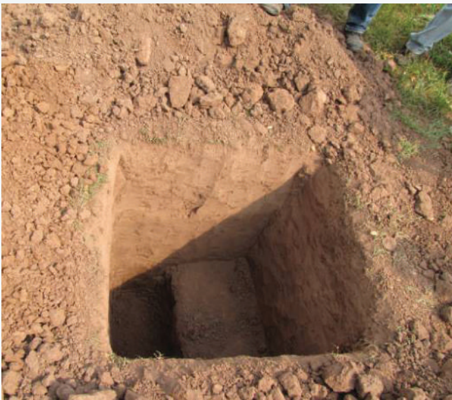
Calicata para la toma de muestra de suelos.
