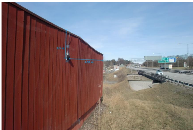
Position 3: mikrofonen hängdes ner 0,5 meter från överkant och 4,85 meter från kanten av bullerplanket.
