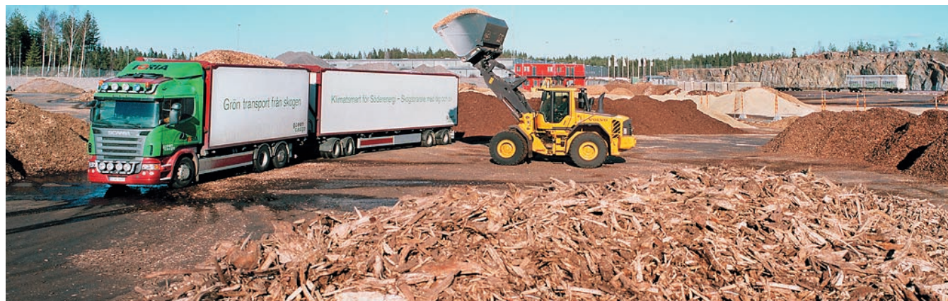
Att minska belastningen från transporter av bränslen är prioriterat. Under 2014 kommer vi att köra den första ETT-flisbilen som ingår i ett forskningsprojekt som bedrivs av Skogforsk för att effektivisera transporter. Bilen kan lasta en tredjedel mer och kommer att köras mellan vår bränsleterminal i Nykvarn (bilden) och Igelstaverket.
