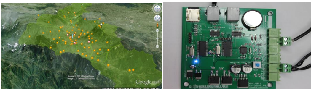
Figura 1. (Izquierda) Distribución de las redes de monitoreo a lo largo y ancho del Valle de Aburrá. (Derecha) Ejemplo de tarjeta controladora y de telemetría desarrollada en el proyecto.
