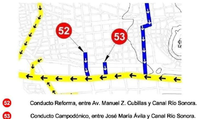
Imagen 22: Obras propuestas para las calles Reforma y Campodónico.
