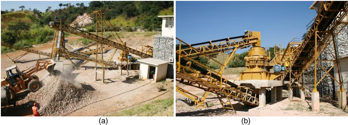
Figura 2 - Unidade de Reciclagem de Resíduos de Construção e Demolição
